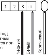
Примечание! Находящийся под напряжением медный обратный провод, который не требуется при подключении, соединяется с отдельной клеммой.
