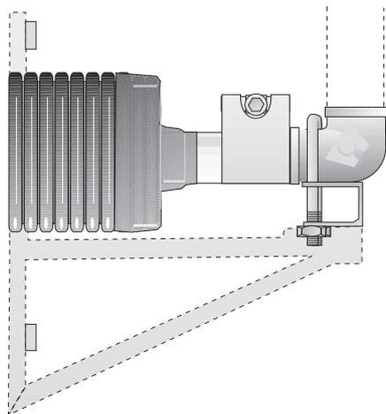
Для анкеровки труб малых диаметров ( $D < 50$ ) достаточно стандартного крепления фитинга хомутами к строительным конструкциям или присоединения к стальным трубопроводам. Анкеровку труб большого диаметра ( $D > 50$ ) следует выполнять, используя специальные муфты с местом крепления.
