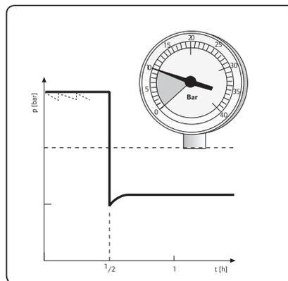
1. Заполните систему водой и выпустите воздух. Отключите от испытываемого участка все элементы, которые могут быть повреждены испытательным давлением.
