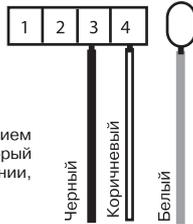
Примечание! Один из находящихся под напряжением резистивных проводов, который не требуется при подключении, соединяется с отдельной клеммой.
