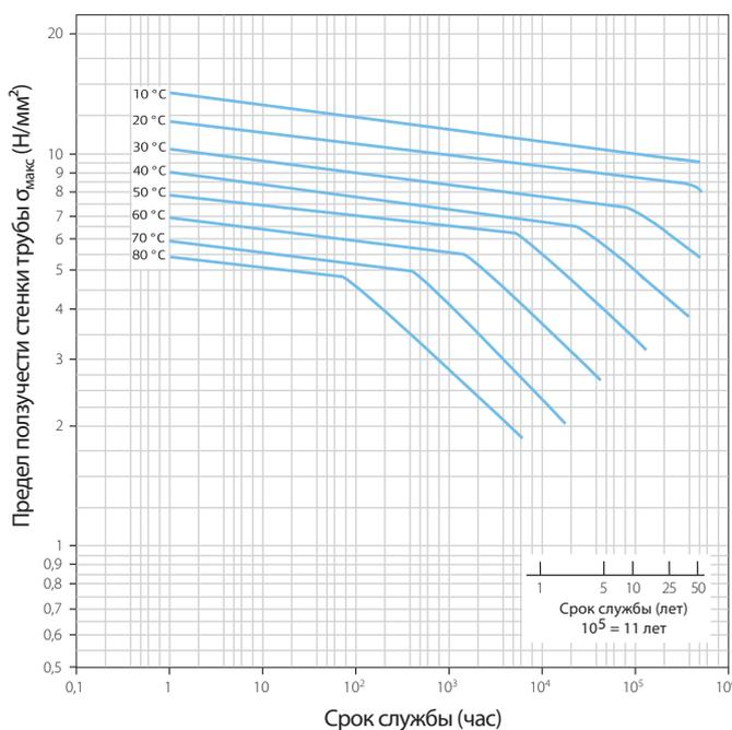
Здесь «Предел ползучести стенки трубы  $\sigma$  (Н/мм<sup>2</sup>)» – это максимальное напряжение в стенке трубы в кольцевом направлении, при котором скорость деформации ползучести или её полная величина не превышают заданных величин.
