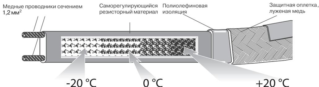
Когда кабель холодный, материал изоляции сжимается, открывая пути прохождения тока в кристаллах углерода материала сердечника. Электрический ток, проходящий через материал сердечника, вызывает нагрев. На теплых участках кабеля полимерный резисторный материал расширяется, уменьшая число путей, по которым проходит
