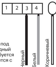
Примечание! Находящийся под напряжением обратный медный проводник, который не требуется для подключения, соединяется с отдельной клеммой.
