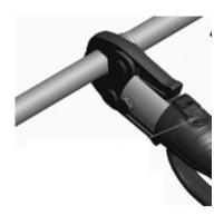
6.8. Нажмите кнопку пуска и выполните соединения. В случае ошибки, нажмите кнопку ручного возврата и вручную верните поршень в исходное положение
