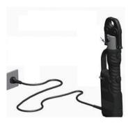
6.5.Включите инструмент в электророзетку 220В. Двойная зеленая вспышка покажет, что микропроцессор производит самодиагностику. Непрерывный зеленый сигнал свидетельствует о положительном результате самодиагностики и готовности инструмента к работе.
