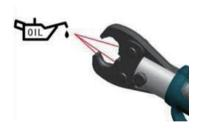
6.10.После завершения работы с инструментом капните каплю машинного масла на ролики штока.
