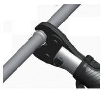
6.7. Для выполнения пресссоединения установите пресснасадку на фитинг так, чтобы монтажный буртик фитинга совпал с соответствующей канавкой пресс-насадки. Обратите внимание, чтобы не было перекоса между осью инструмента и осью пресснасадки—это может привести к опасным повреждениям
