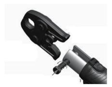
6.4. Нажмите и поверните стопорный палец 2, при этом за счет пружины он выдвинется. Вставьте пресснасадку, нажмите и поверните стопорный палец.
