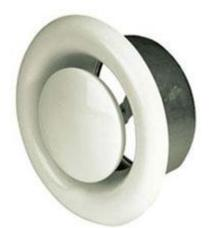
Диффузоры VE...М предназначены для применения в вытяжных системах вентиляции и кондиционирования. Они представляют собой потолочные воздухораспределительные элементы с плавным регулированием расхода воздуха, которое осуществляется с помощью вращения центрального диска. Диффузоры изготавливаются из стали и имеют защитное порошковое покрытие белого цвета. Для удобства монтажа диффузоры снабжены соединительной муфтой, с помощью которой они присоединяются к воздуховодам.
